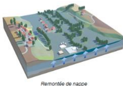
Figure 18. Schématisation d'une remontée de nappe (source : prim.net)
